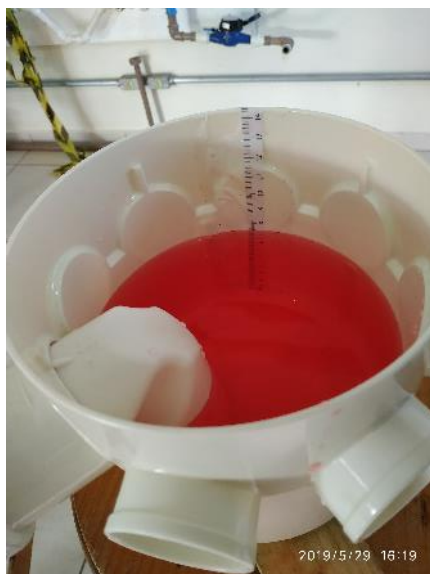
Figura 6 - Fita graduada fixada na caixa sifonada
