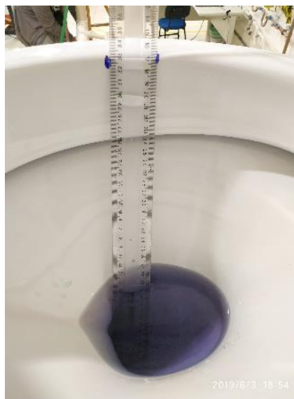
Figura 7 - Régua fixada na bacia sanitária
