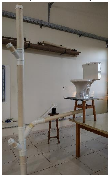
FIGURA 2 - Protótipo com a ventilação totalmente restringida
